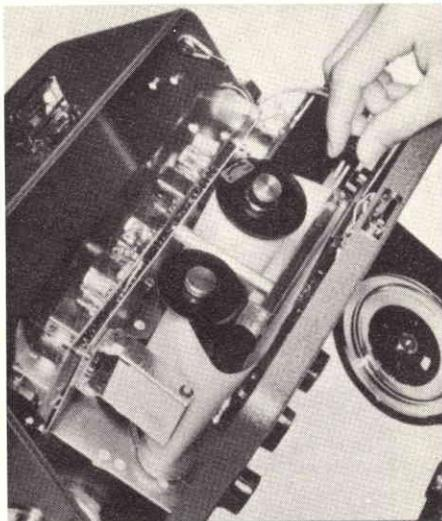
Fig.13 - Siamo sempre nel campo delle nuove professioni. Messa a punto di un moderno apparecchio per ecoscandaglio ultrasonoro (FURUNO, MARK-3, della S.I. R.M.J.).
