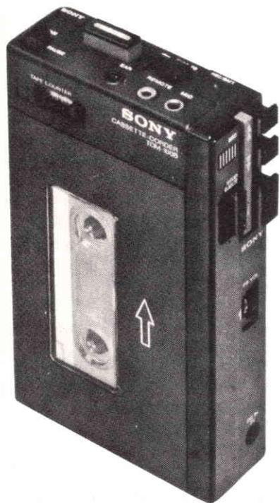
Fig. 2 - Esempio di registratori Sony di minime dimensioni, nel quale viene impiegato un motorino elettrico senza nucleo, con notevoli vantaggi agli effetti delle dimensioni, del peso e del consumo di energia.
