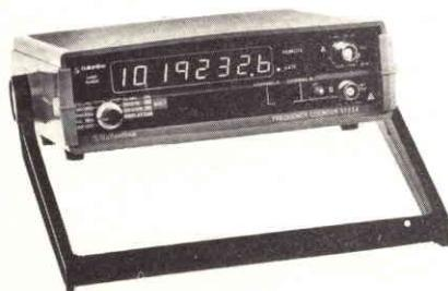
**Frequenzimetro portatile da 1,25 GHz.**
