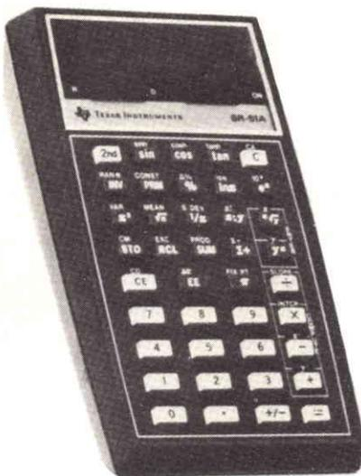
Fig. 1 - Calcolatrice professionale TEXAS, modello SR 51, alimentata con pile ricaricabili ed alimentatore fornito nella confezione (codice GBC ZZ/9946-20).
